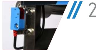
Outre un bouton physique, le Tornado dispose également d'un œil électronique qui sert d'arrêt d'urgence.
