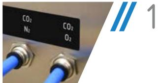
Chaque appareil dispose de deux raccords pour des mélanges de gaz différents : la viande fraîche et les produits cuits peuvent être utilisés sur le même appareil. Ils sont scellés dans une atmosphère différente et modifiée :
