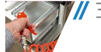
Presque tous les appareils disposent d'un raccord supplémentaire pour l'air comprimé, par exemple pour un pistolet à air comprimé destiné à nettoyer l'appareil.
